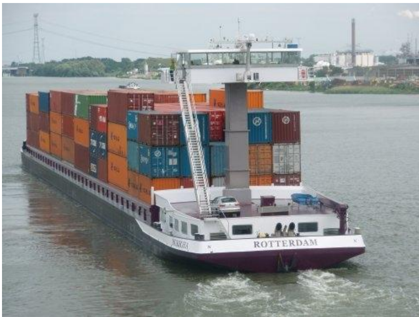
Dubbelwandig uitgevoerd containerschip Duricha
